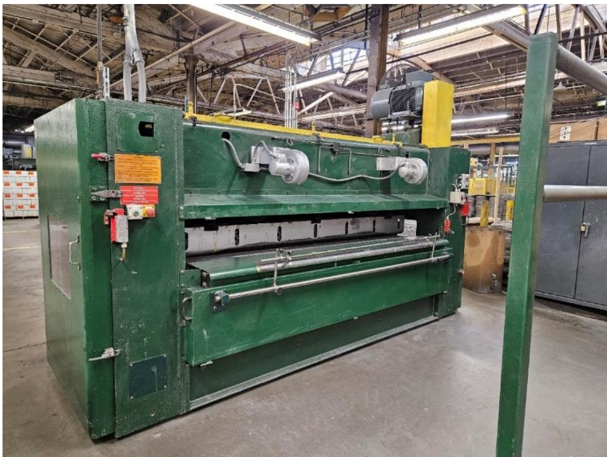
Foto nº 01 – Vista da parte frontal da Agulhadeira para fabricação de manta de velour (falso tecido aveludado) de baixa gramatura e superfície de pelos uniformes com formação randômica, modelo DI-LOUR II 25 e fabricante DILO Machines GmbH – Alemanha.
