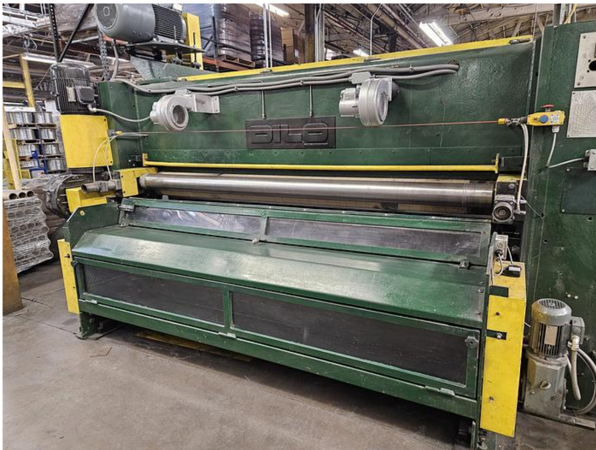
Foto nº 02 – Vista da parte traseira da Agulhadeira para fabricação de manta de velour (falso tecido aveludado) de baixa gramatura e superfície de pelos uniformes com formação randômica, modelo DI-LOUR II 25 e fabricante DILO Machines GmbH – Alemanha.
