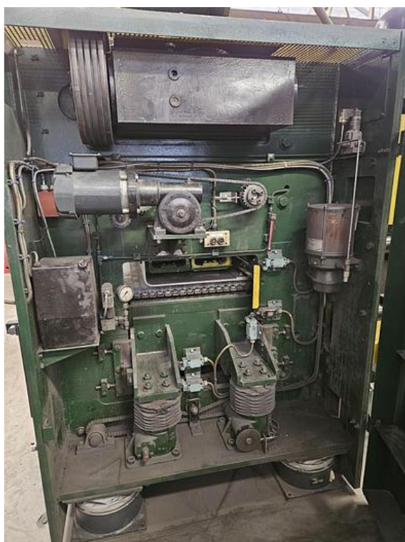
Foto n° 04 – Vistas de outros componentes localizados na parte interna da Agulhadeira modelo DI-LOUR II 25 e fabricante DILO Machines GmbH – Alemanha.
